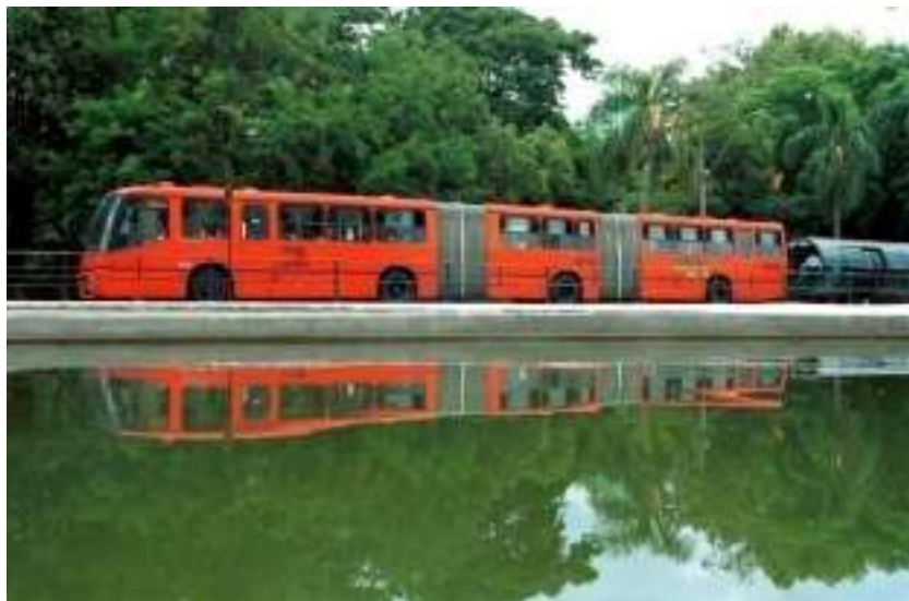
Figura 2 - Ônibus Biarticulado – canaleta exclusiva. Fonte: Banco de Imagens do IPPUC (2010).
